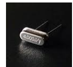
Un quartz avec \nu_0 = 4 \text{ MHz}
